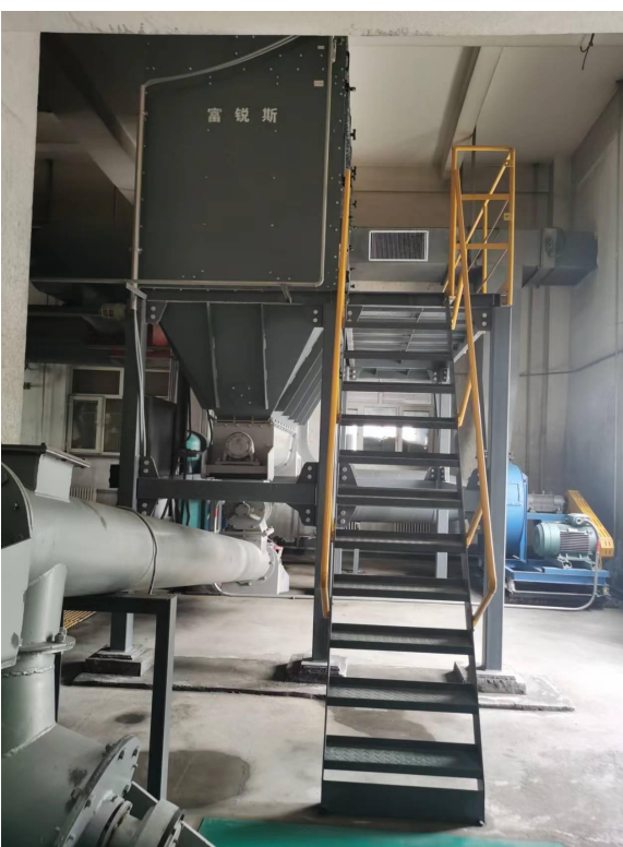
筛分破碎站的喷雾除尘设备和烧结板除尘器
