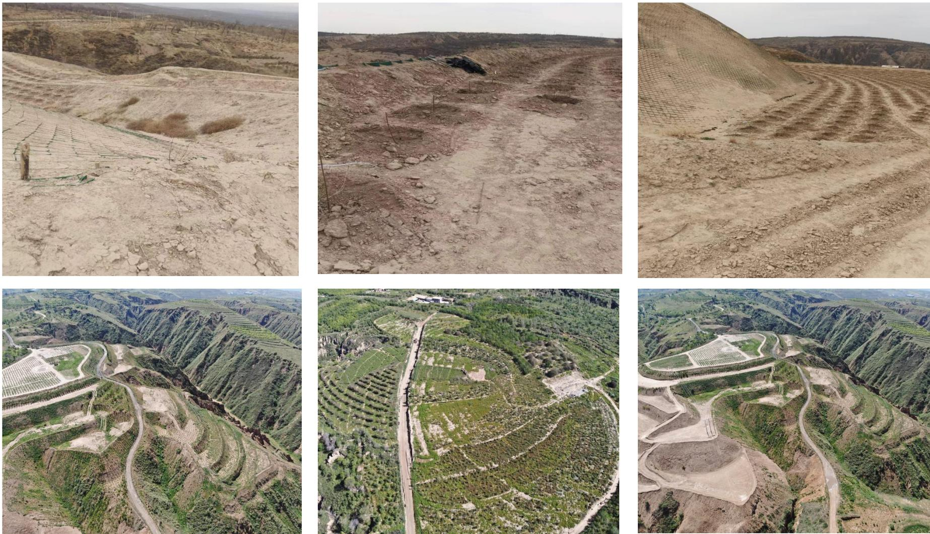
图5.4.3-1沉陷区裂缝土地平整及植被恢复情况
